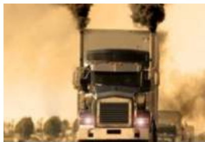
Detekcja pojazdów z niewydolnym filtrem cząstek stałych DPF lub ADBLue.
