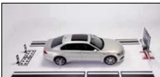
Kompleksowa kalibracja systemów ADAS
