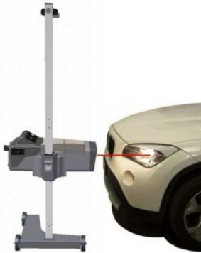
Bazowanie laserowe wzg. środka reflektora
